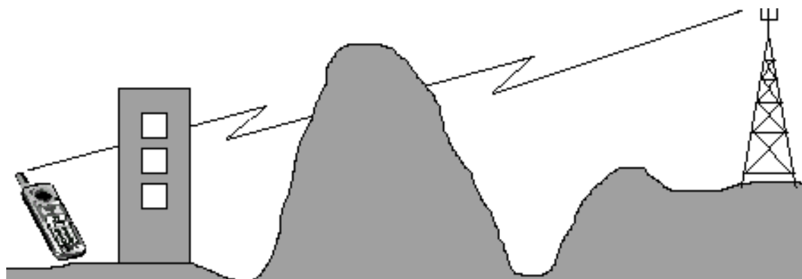
2.7-сурет – Радиосигналдарды тарату жолындағы кедергілер
